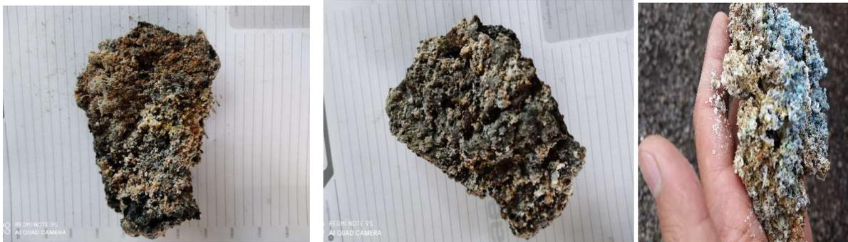
**Figura 10.** Piezas de ceniza sinterizada identificadas en la zona baja del intercambiador de calor luego de la campaña experimental en el quemador de lecho fijo y propagación de llama horizontal en APROCCE utilizando pellets de fibra de mesocarpio como biocombustible.
