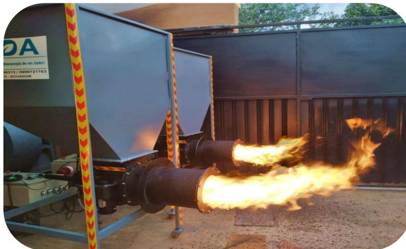
**Figura 6.** Sistema de combustión de lecho fijo y propagación de llama vertical instalado en las asociaciones KALLARI, APROCCE, ASOMACHE y PRIMAVERA.
