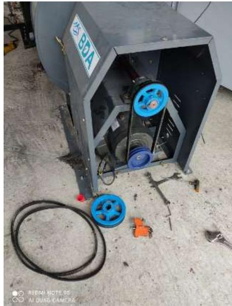
**Figura 21.** Ajuste volumétrico y de rendimiento de la turbina Soler&Paulau modelo CM 450, airfoil (5HP) ejecutado por el equipo técnico de BDA en campo. Presupuesto y partida propia.
