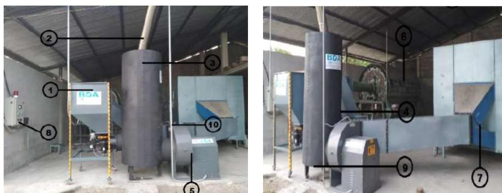
**Figura 4.** Sistema de combustión de agro-residuos de lecho fijo y propagación de llama horizontal instalado en APROCCE y PRIMAVERA. 1. Tolva de almacenamiento, 2. Ducto evacuación de gases de combustión, 3. Intercambiador de calor, 4. Compuerta de inspección, 5. Soplador industrial, 6. Secadora rotativa tipo guardiola, 7. Secadora de cama fija en 2 niveles, 8. Tablero de control automático, 9. Compuerta de evacuación de ceniza.
