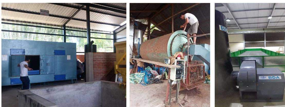
**Figura 3.** Sistemas de secado mecánico identificados en las organizaciones intervenidas. De izquierda a derecha: Secador de cama y lecho fijo con 2 niveles (secado y pre secado) en la organización APROCEL. Secadora rotativa del tipo guardiola en la organización Primavera Oriental y Secador cama lecho fijo de 1 nivel en Kallari.
