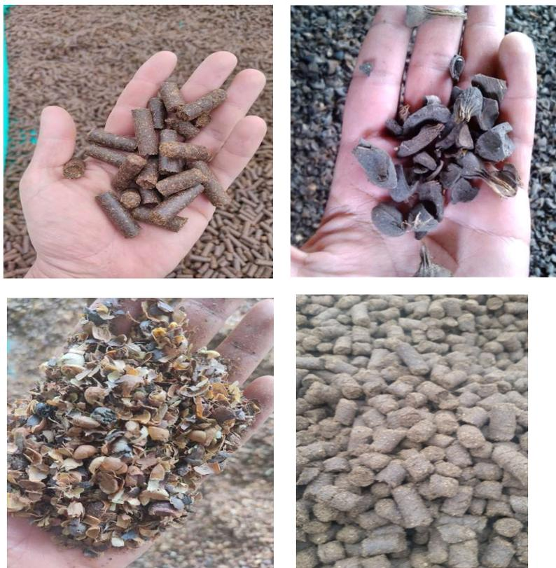
**Figura 8.** De izquierda a derecha. Arriba i) pellets de cascarilla y ii) cáscara de palma africana. Abajo: iii) cascarilla de café (4:1 %vol) y iv) pellets de fibra de mesocarpio.
