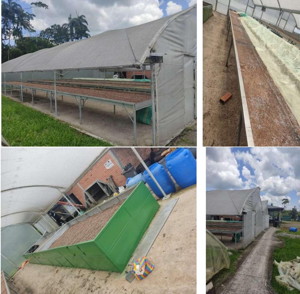
**Figura 19.** Sistema híbrido de secado actualmente instalado en la organización APROCEL.
